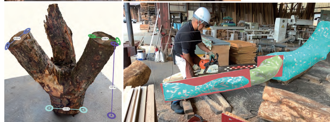
「曲がり木センター」には萌芽更新した樹幹や曲がり木、AR技術を用いて加工された木材など“調理前”のものも“調理後”のものもあり、見ているだけで楽しい。左は3Dスキャンデータの例。下は職人がARゴーグルを付けてチェーンソーで加工している様子。（下の写真：AHA浜田晶則建築設計事務所）
