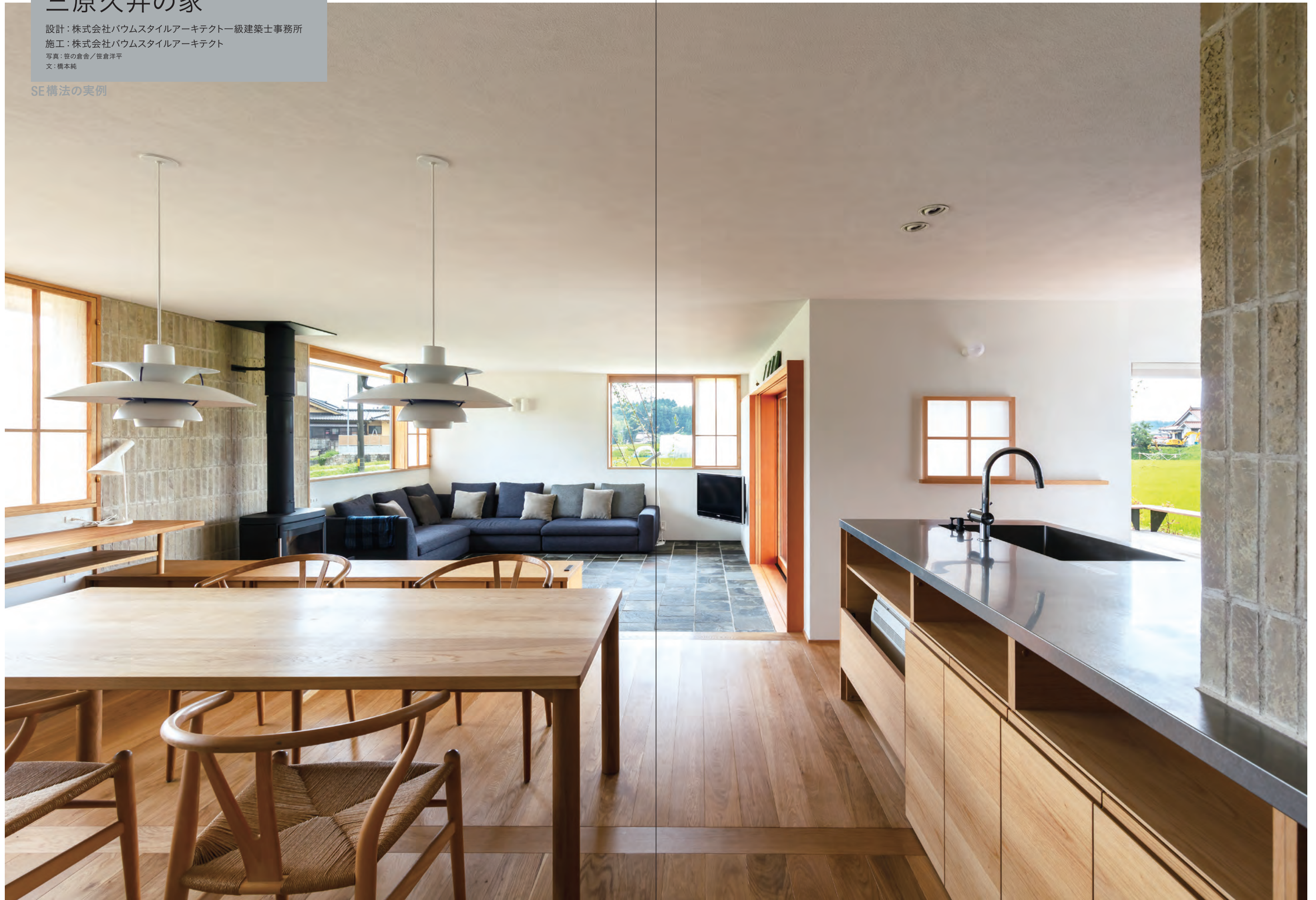
ダイニングからリビング方向を見る。天井高は手前のダイニングが2,200mm、180mm床レベルを下げたリビングで2,380mm。天井は珪藻土塗り仕上げ。
