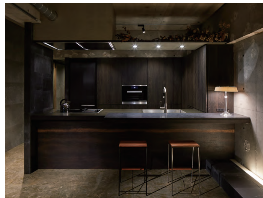
和田浩一さんが設計した「入船studio」。キッチンは黒を基調とし、収納の面材には「ボグオーク」の突板、カウンター下にはユーカリの玉壺を燻蒸した突板の化粧合板を採用。ボグオークはいわゆる「神代木」で、長い年月をかけて泥の中で炭化して石のように硬くなり、ダイヤモンド刃でないとスライスできないほどだという。(写真：Nacasa & Partners)
