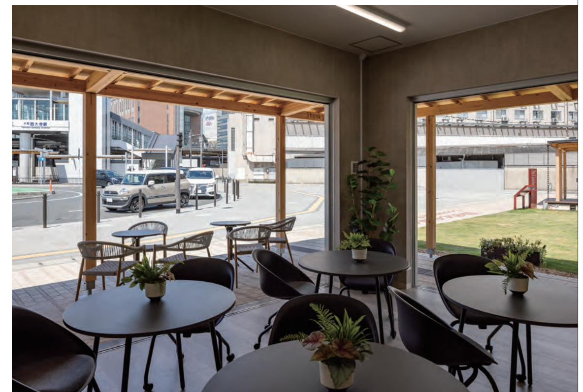
左頁：A棟の下屋空間から芝生広場を見る。下屋の架構は主要構造体ではないこと、庇の梁とA棟の架構の接合部の間にも耐火被覆を施したことで、木部の現し仕上げが認められ、下屋空間の軽やかさを生み出している。
