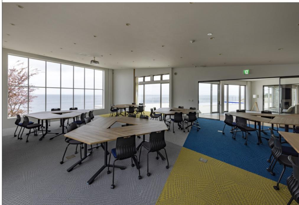
上：研修ホールを見る。右手にエントランス、リビングが連なる。研修ホールとエントランスの間の開口部は幅5,100mmで、5枚引きのスティール製引き戸（サンワカンパニー製）がはまる。その上部には成750mmの大きな梁が架かる。
