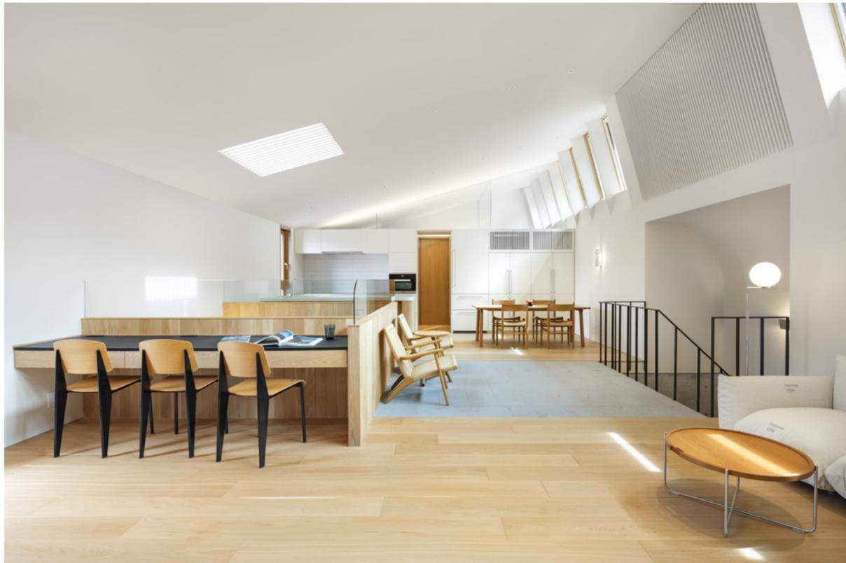
天窓から得られるさまざまな効果のなかで、もっとも代表的なのが「採光」と「通風・換気」です。ご存知の通り建築基準法では、採光に有効な窓を住宅の居室では床面積の1/7以上設けることが定められています。その有効採光面積の算定時に用いる採光補正係数が天窓は原則「3.0」で、側窓(外壁面に設けた窓)の3倍の採光効果があるとみなされます(ただし、光井戸のように天窓と居室空間が離れている場合などは採光補正係数の算定が別途必要)。つまり側窓の1/3の大きさで規定の採光を得られるわけですから、いかに効率がよいかおわかりいただけるでしょう。開口部が小さければ、そのぶん熱損失も抑えられます。天窓の採光効果が高いのは、天空光をたっぷり拾うからです。自然光(昼光)は直射光、天
