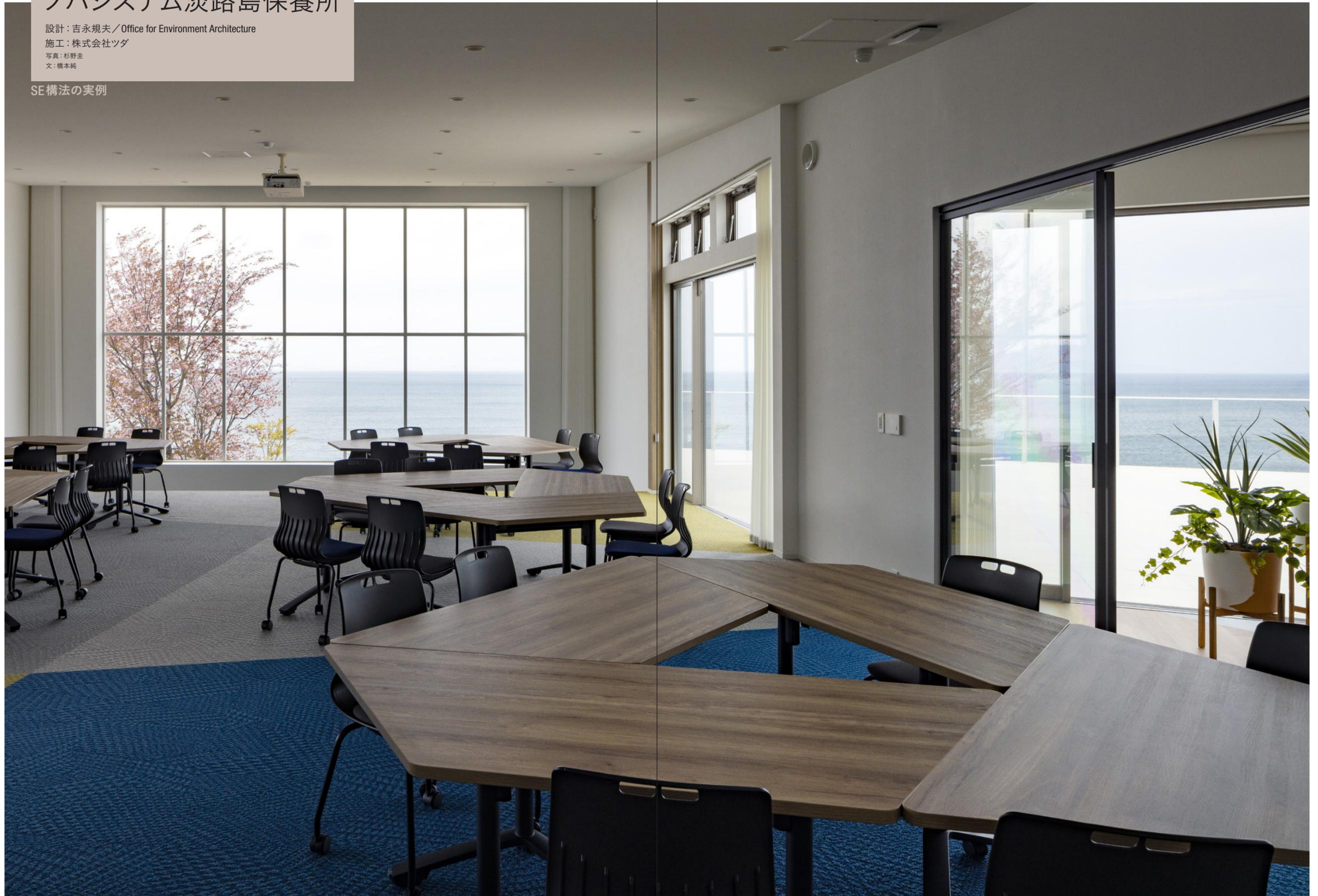
研修ホールから西側に広がる瀬戸内海を望む。左右8,645mmのワンスパン。正面の開口部の寸法は6,375mm×3,950mm。その両端の袖壁は幅910mmで、それぞれ120mm×240mmの平角柱4本で構成されている。左手の山桜は既存樹木。
