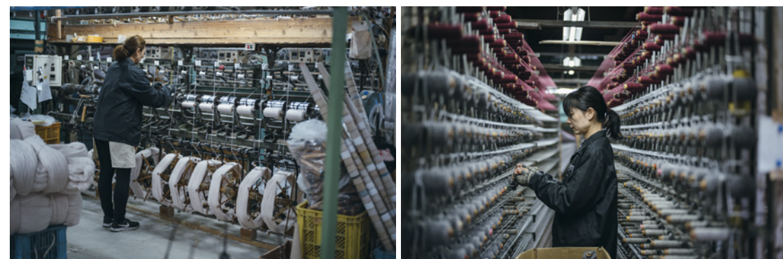
大阪府和泉市にある堀田カーペットの本社工場。同社は国内でも稀少な「ウィルトン織機」を使ってカーペットを織っている。左は、木の芯(木管)に糸を巻きつけて「コマ」をつくる「ワインダー」という工程、右は「クリール」にコマを手作業でセットするところ。クリールから糸が織機に供給される。
