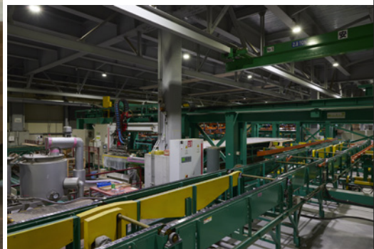
2016年から稼働している国内初のCLT量産工場。JAS認定のCLT工場8社のなかで製造能力はトップで、最大3×12mまで製造可能だ。3×12mの大判を製造できる工場は2社しかない。CLTは値段が高いと思われているが、「ヨーロッパはほとんど変わらない」と中島社長は話す。
