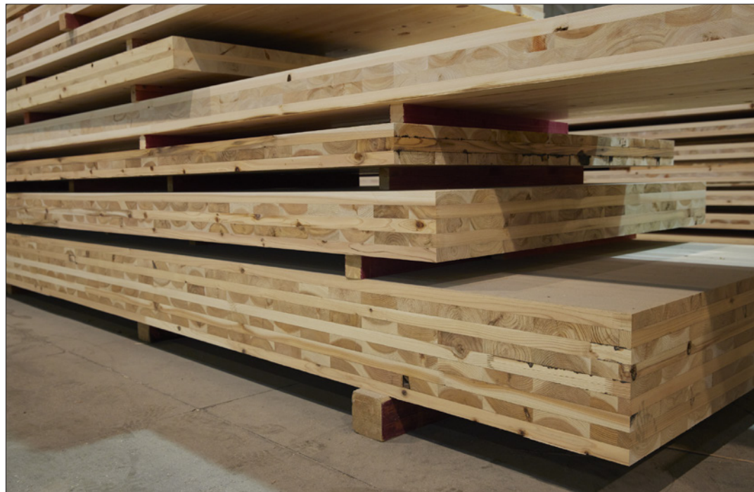
2016年から稼働している国内初のCLT量産工場。JAS認定のCLT工場8社のなかで製造能力はトップで、最大3×12mまで製造可能だ。3×12mの大判を製造できる工場は2社しかない。CLTは値段が高いと思われているが、「ヨーロッパはほとんど変わらない」と中島社長は話す。
