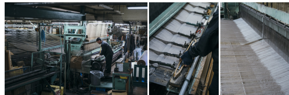
織機は幅約10m、長さ20mほどと大きい。クリールから引った糸を巻糸(たいてい)として、「シャトル」にセットされた緯糸(よこいと)を生地幅方向に往復させて織り込んでいく。ジュート麻の「地糸」やポリエステルの「シメ糸」も一緒に織り込むので、すべての糸を合わせると1万本ほどになる。
